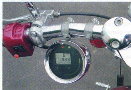
Комбинированный прибор: велоспидометр на жидкокристаллическом дисплее + тахометр на светодиодах.
